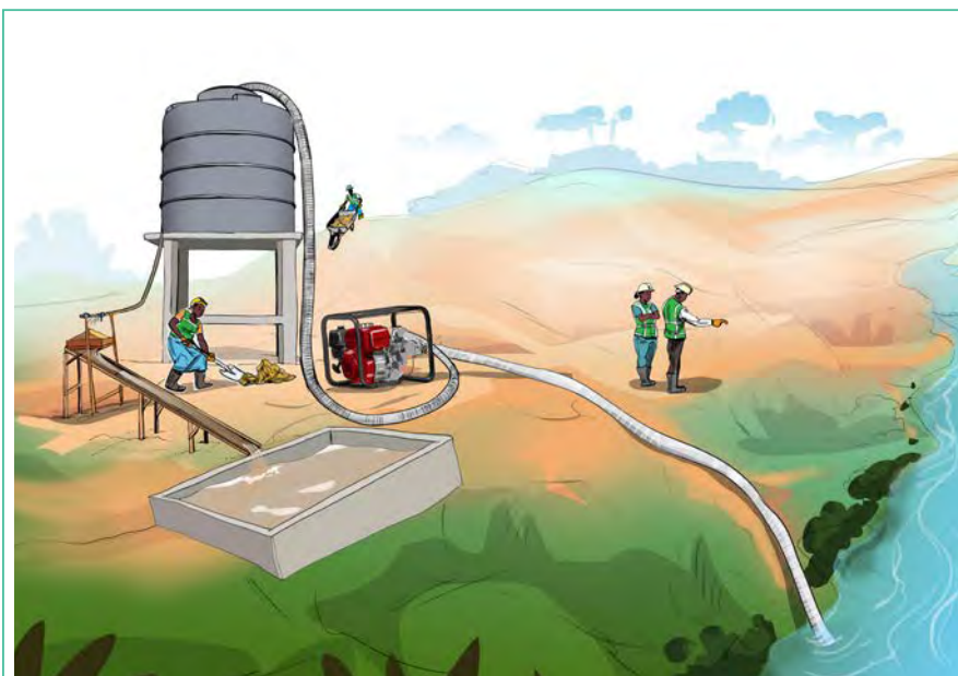
Image 31 : Une motopompe fournit l'eau de traitement pour le lavage à l'écluse.
