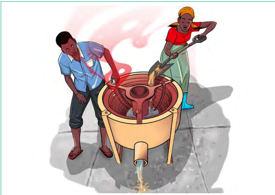
Image 15 : Une pratique dangereuse consiste à ajouter du mercure aux concentrateurs centrifuges.
