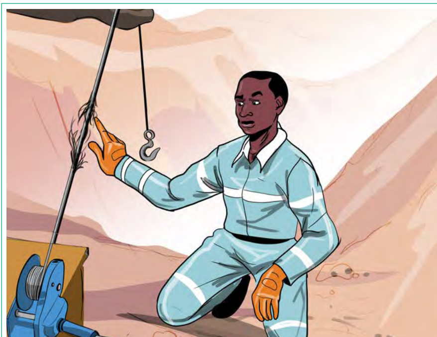
Image 15 : Vérifier s'il y a des bris dans le câble de levage du treuil et le remplacer immédiatement le cas échéant.
