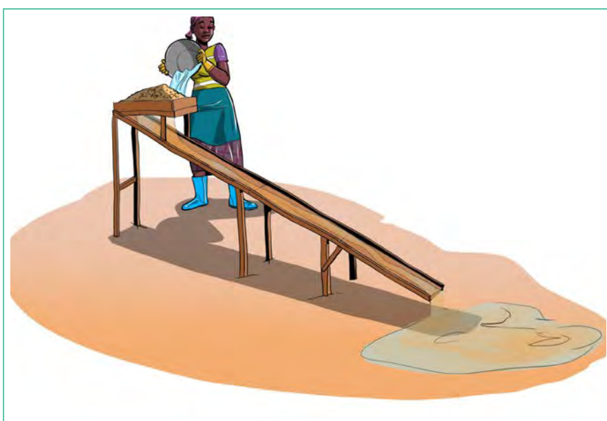
Image 23 : Lavage à l'écluse.
