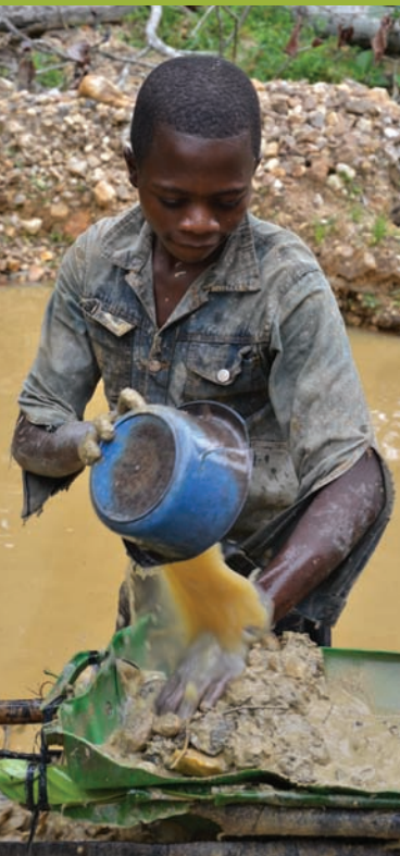
Un creuseur artisanal à Mangi, Province Orientale (République démocratique du Congo), utilise l'équipement conçu localement à partir de matériaux simples pour séparer l'or de la terre. Joanne Lebert/PAC
